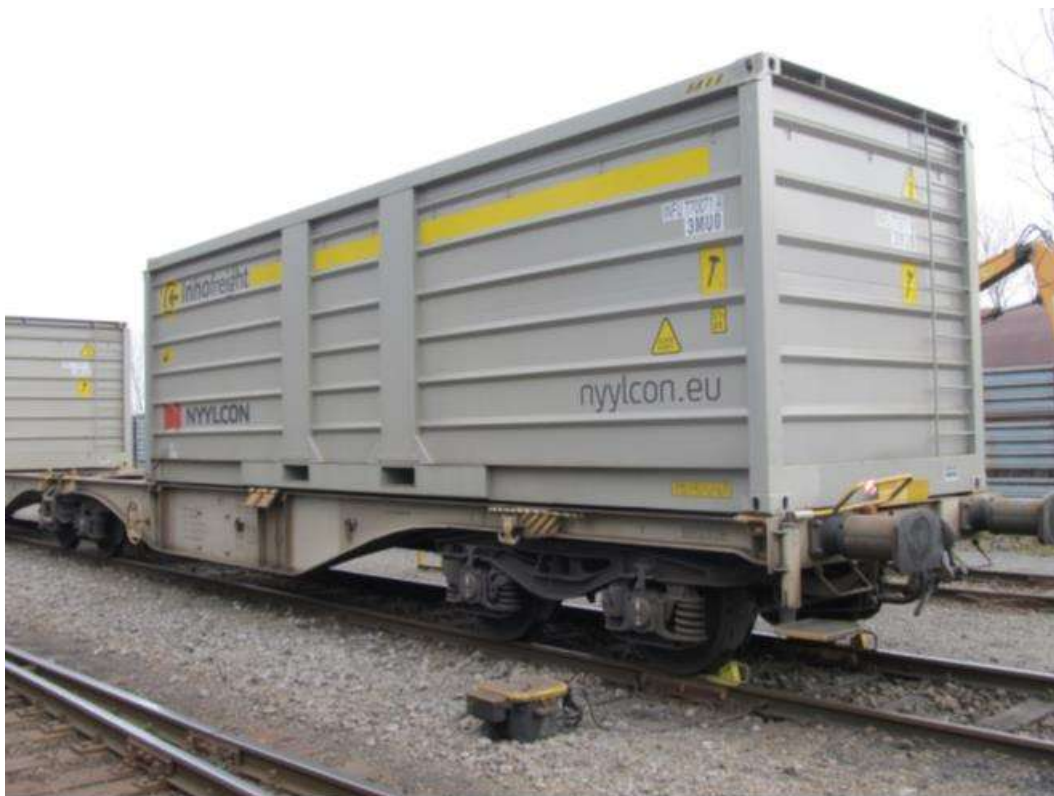
Obrázek 19: Převážní kontejnery v systému Innofreight
