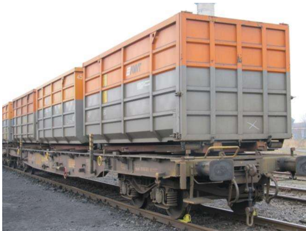
Obrázek 18: Převravní kontejnery v systému ACTS
