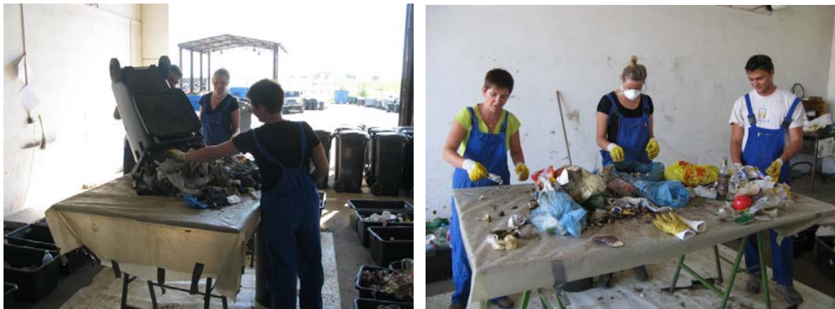
Abb. 2.5: Entleerung einer 20 kg-Stichprobe auf dem Sortiertisch (links), händische Sortierung in Fraktionen (rechts)
